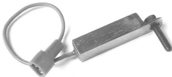
**Bild 6: Zwei 300V-Suppressor-Dioden in einem Kühlkörper aus hohlgebohrtem Messing**
