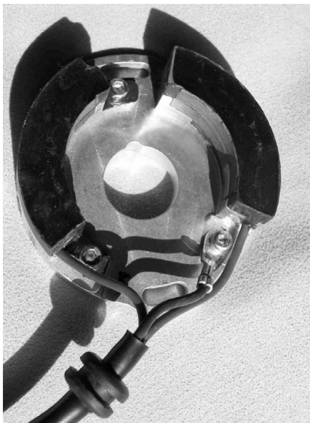
Bild 4 Detailansicht des fertig vergossenen Pickups
