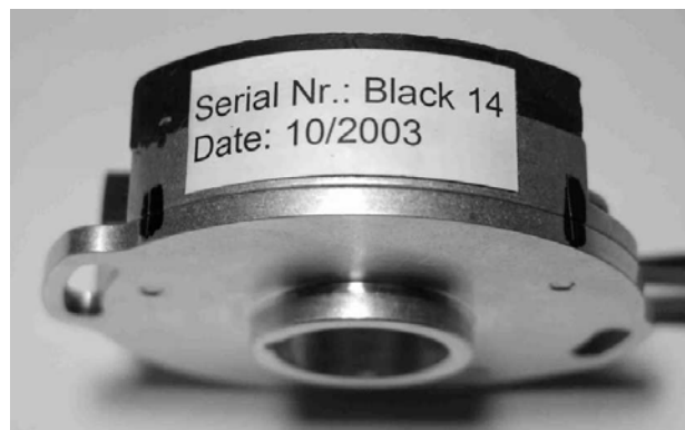
Bild 6 Serienaufkleber und Einstellmarkierungen auf Zylinder 2
