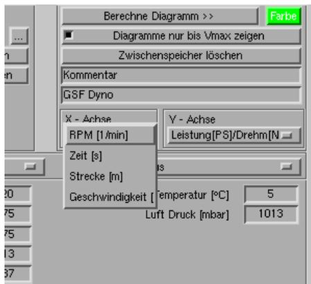
15. Hier wird eingestellt, was die Software auf der Y-Achse anzeigen soll.
